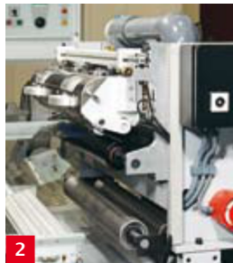
2 Korona-Behandlung Zur Verbesserung der Haftung von Farben und Lacken werden Kunststoff-Folien mit Korona vorbehandelt.
