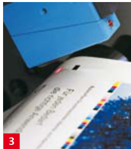
3 Bahneingaberegulation Integriert in das Einzugwerk für registergenauen mehrmaligen Bahndurchlauf mit Sensoren für Vorder- und Rückseite.
