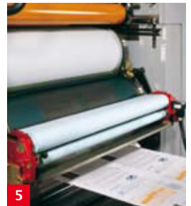
5 Gummituchwaschanlage Die Druckwerke sind serienmässig für den Anbau einer Gummituchwaschanlage vorbereitet.
