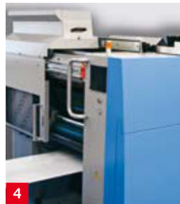
4 Ergonomische Verkleidungen Durchgängiges Verkleidungskonzept für optimale Zugänglichkeit zu den Farbwalzen ohne Demontage von Blechteilen.
