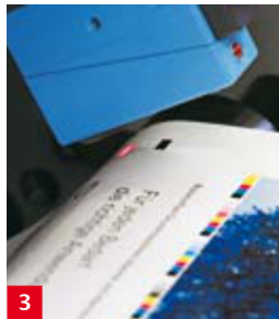
3 Dispositif de réinsertion de bande Totalemnt intégré au débitEUR pour le passage multiple de la bande en parfait registre, avec détecteurs recto-verso.
