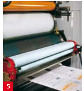
5 Laveur de blanchets Les blocs-formats sont préparés en usine pour le montage d'un laveur de blanchets.
