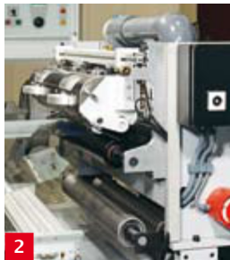
2 Traitement Corona Pour une meilleure adhérence des encres et vernis, les films en plastique subissent un prétraitement Corona.
